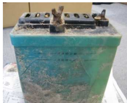
投棄されていた空気湿電池 上：縦 11 cm × 横 23.5 cm × 高さ 19 cm 下：縦 8.5 cm × 横 14.8 cm × 高さ 17 cm
